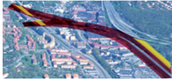
Alternativ Haga - Chalmers. Tunneln övergår från berg till lera söder om Liseberg. Här uppstår konflikter med trafiken på Mölndalsvägen och på Sofierogatan. Även verksamheten vid SAAB:s växellådsfabrik påverkas. Bilden visar också läget för E6/Rv40 under byggskedet (gult) samt Västlänkens anslutning till Västlänken.
