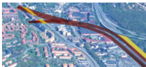
Tunneln övergår från berg till lera söder om Liseberg. Här uppstår konflikter med trafiken på Mölndalsvägen och på Sofierogatan. Även verksamheten vid SAAB:s växellådsfabrik påverkas.
